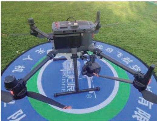
应急监测人员使用无人机采水样
