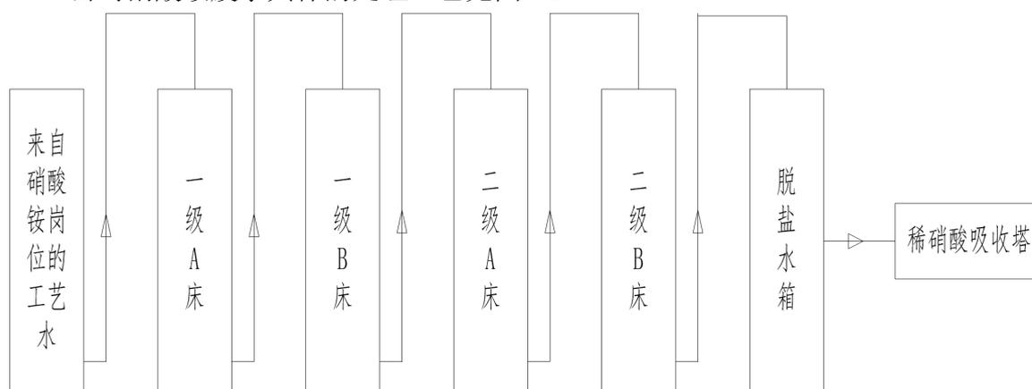
图 4.1 硝酸铵废水具体的处理工艺
